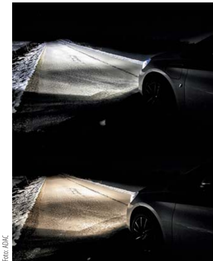
Unterschied wie Tag und Nacht: LED-Lampe (o.) im Vergleich zu Halogen (u.).
