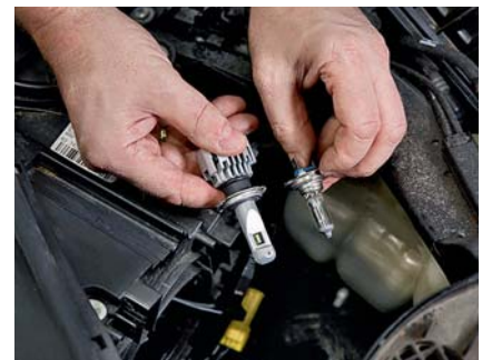
Die LED-Lampe (l.) ist wegen des Kühlkörpers größer als die Halogen-Variante.
