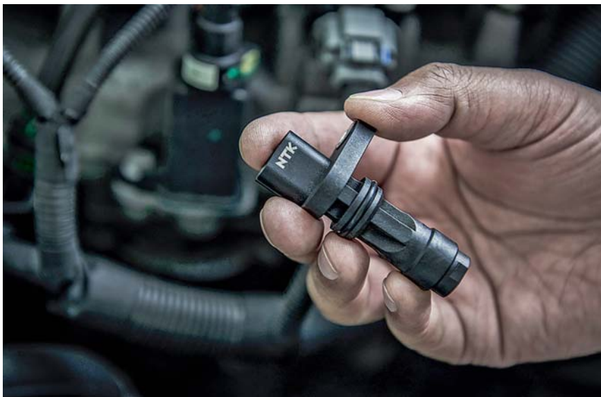
Kurbelwellensensoren geben Drehzahl und Position der Kurbelwelle an das Steuergerät weiter.
