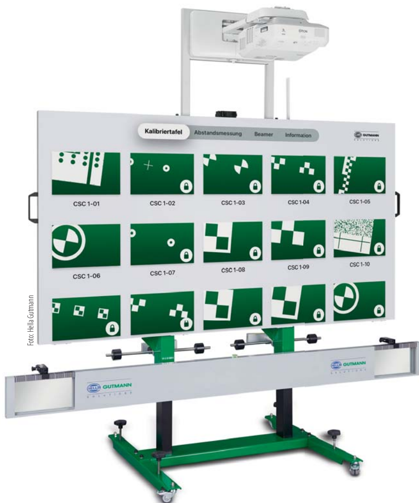
Beim CSC-Tool Digital werden die Kalibriertargets auf die Tafel projiziert.
