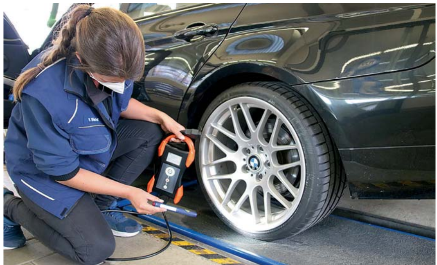
Vieles, aber nicht alles geht heute digital: Die Sichtprüfung bleibt unverzichtbar bei der HU.
