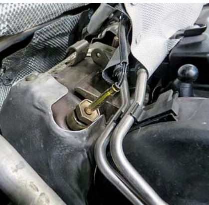
Abgastemperatur-Sensoren müssen hohe Temperaturen vertragen können.
