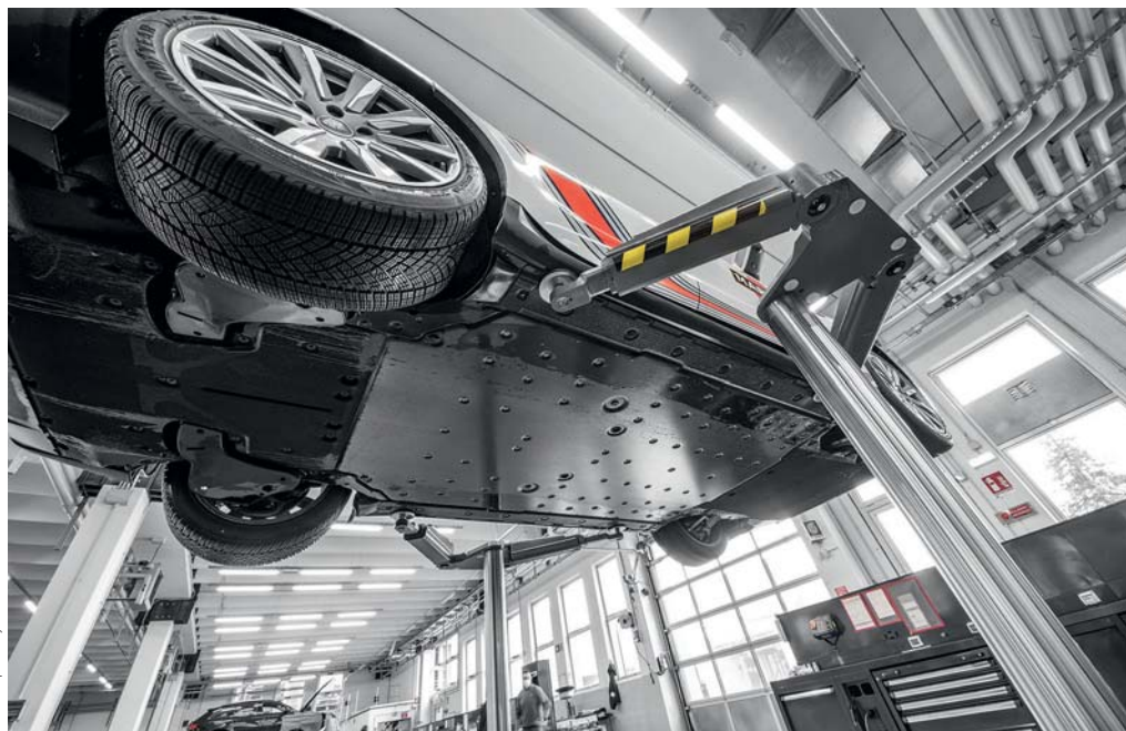
Unterflurböhlen wie die Masterlift Saa 2.35 von AutopStenhoj sind für tief liegende Fahrzeuge, aber auch Transporter und sogar E-Autos geeignet. Der Unterboden bleibt frei zugänglich.
