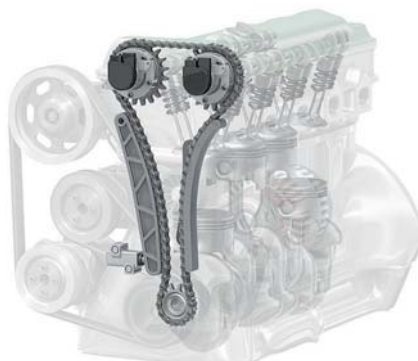
Steuerketten können bei Einhaltung der Serviceintervalle ein Fahrzeugleben halten.
