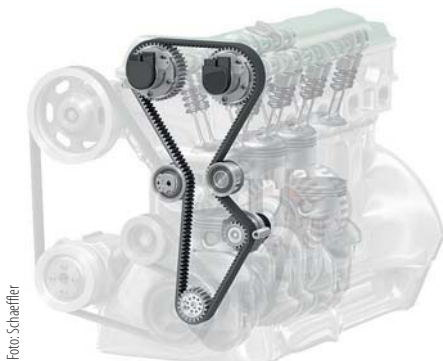
Zahnriemen haben inzwischen sehr lange Wartungsintervalle und sind generell sehr leise.
