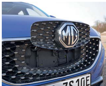
Witzig: Die Ladebuchse des MG ZS EV findet sich direkt unter dem MG-Logo.
