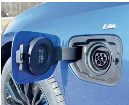
Über die Typ-2-Buchse auf der Vorderseite wird die Batterie des 330e geladen.
