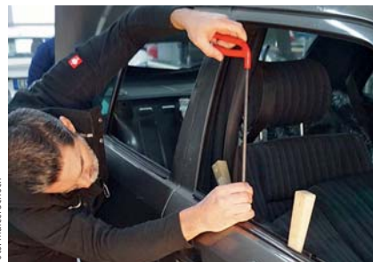
Viel Gefühl und ein gutes Auge sind nötig, um Dellen aus einem Türblech zu drücken.
