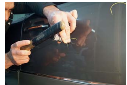
Nach dem Herausdrücken der Delle muss die entstandene Beule mit einem Teflon-Schlagdorn am Rand egalisiert werden.
