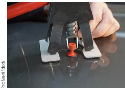
An von hinten unzugänglichen Stellen wird zum Herausziehen der Dellen ein Kunststoffadapter auf die Karosserie geklebt.
