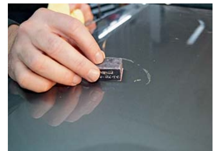
Wenn der Kunststoffadapter abgezogen ist, kann die Reparaturstelle vorsichtig geschliffen und poliert werden.
