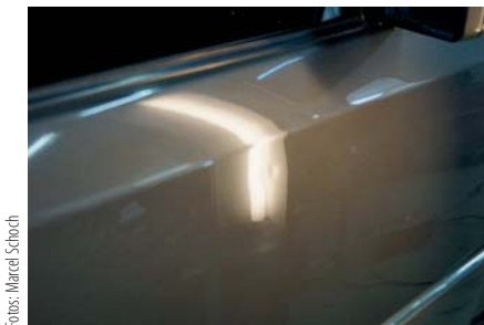
Im Lichtschein der Karosserielampe erkennt Andreas Kalman, wo die Delle genau sitzt und wie er sie herausmassieren kann.
