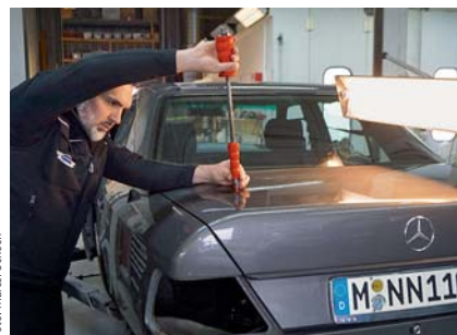
Tiefere kleinere Dellen werden mithilfe eines Zughammers vorsichtig aus der Karosserie gezogen.
