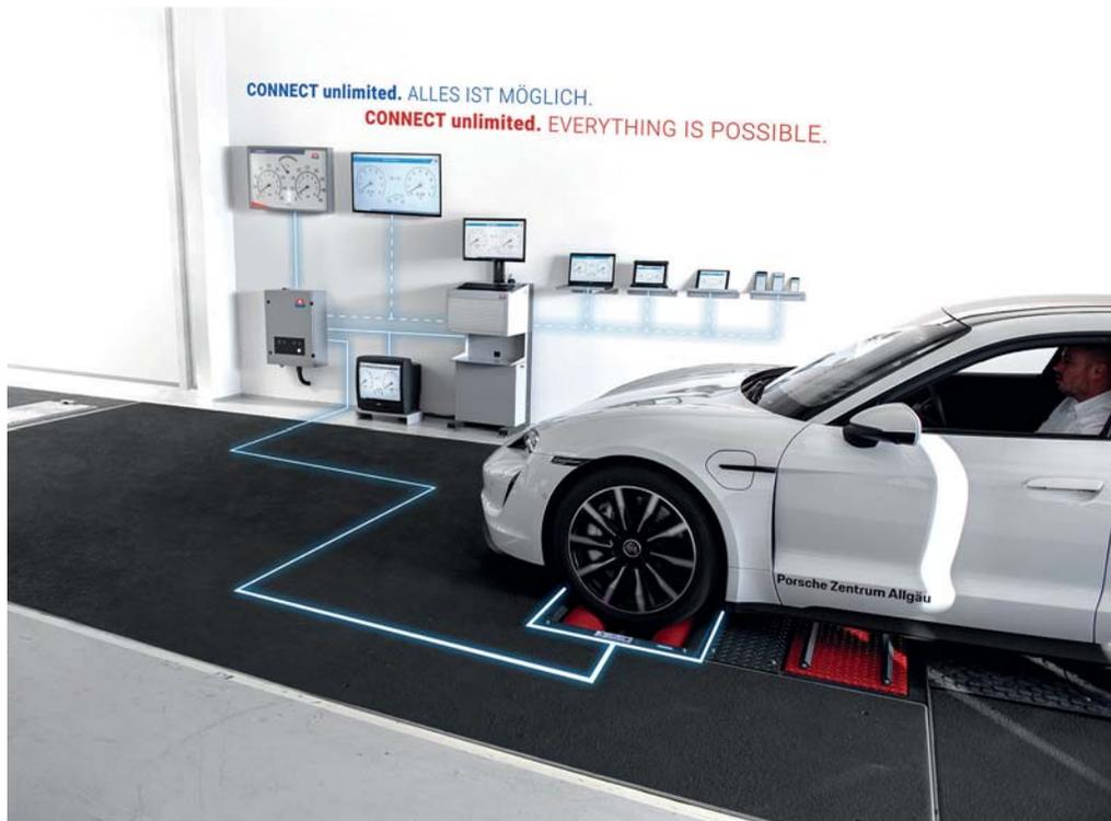
**Ganz neue Möglichkeiten der Konnektivität mit den unterschiedlichsten Anzeigegeräten erlaubt der neue Bremsprüfstand von MAHA.**
