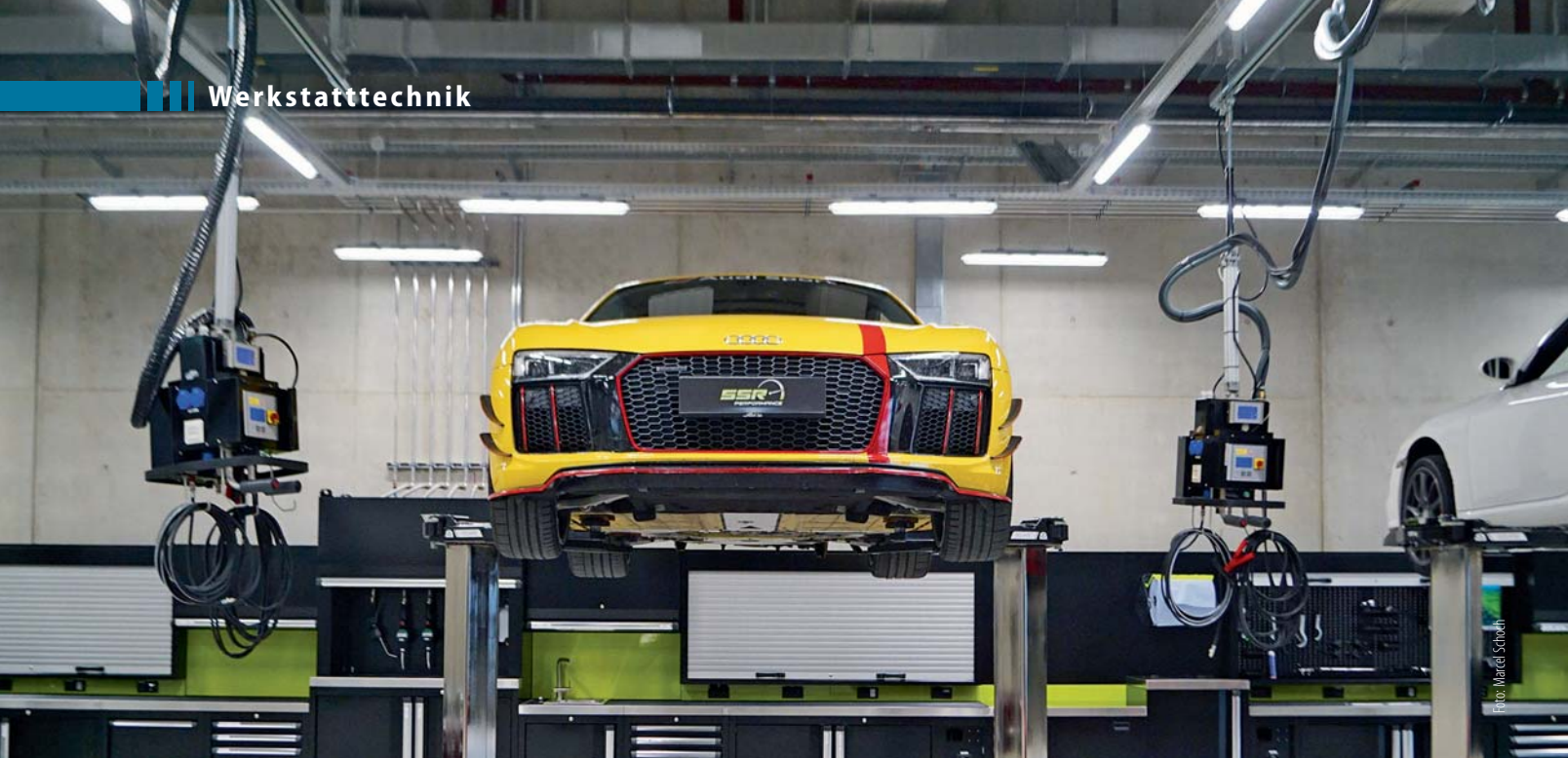
Die MAHA-Zwei-Stempel-Unterflurhebephöhne des Typs ZS Square II 3.5 SP hebt Fahrzeuge über zwei Meter hoch.
