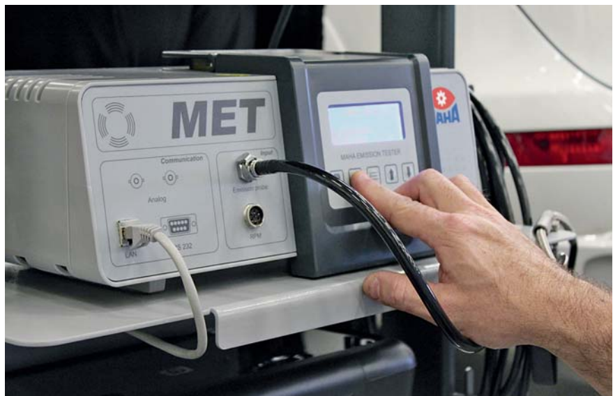
MAHA nutzt die DC-Messmethode für sein Messgerät – wegen der hohen Nutzerfreundlichkeit.
