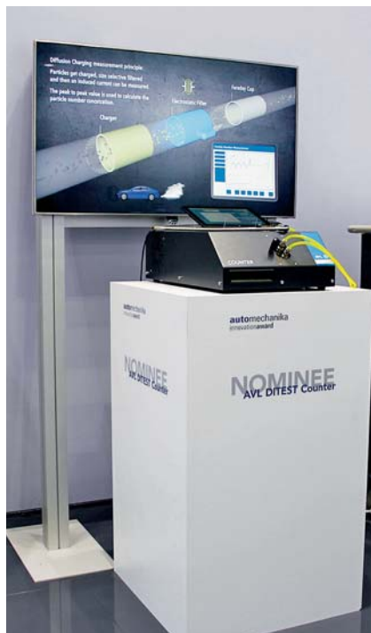
AVL Ditest setzt auf die Messmethode „Advanced Diffusion Charging“
