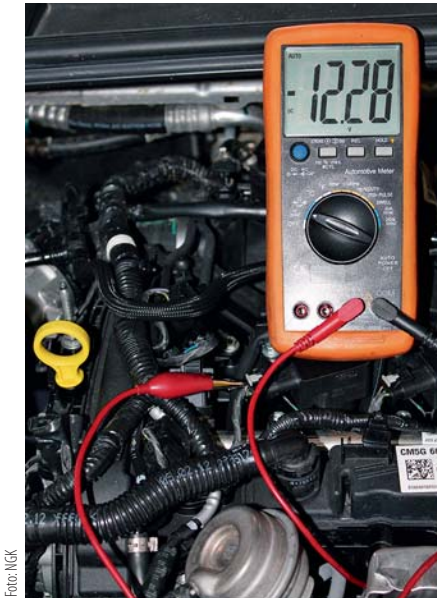
Prüfung der Zündspule in Bezug auf die Masse. Hier sollte die Batteriespannung (Minus) stehen.
