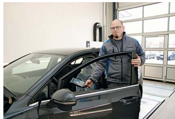
Das VCI DoD 2.0 wird an die OBD-Schnittstelle des Fahrzeugs angeschlossen.
