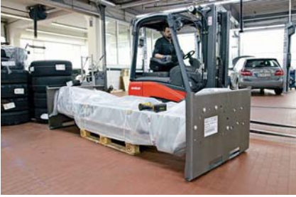
Schritt 1: Die komplette Bühne passt auf eine Europalette. Eine aufwendige Holzverpackung entfällt, das spart Entsorgungskosten.
