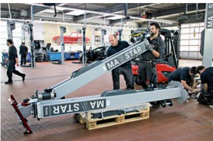
Schritt 4: Das sichere Aufstellen der Säulen erfolgt mittels Aufstellhilfe am Fußende. Dies erfordert trotzdem etwas Muskelkraft.
