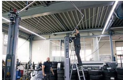
Schritt 8: Die patentierte, klappbare Kabelbrücke erleichtert die Montage und verkürzt die Aufbauzeit deutlich.
