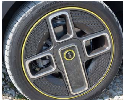
Die Felgen des Mini SE sind sehr markant und sollen auch den Luftwiderstand reduzieren.
