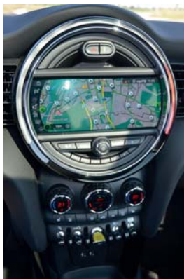
Viel Show: Der LED-Ring, der das Display umrandet, kann je nach Fahrprogramm die Farbe wechseln.
