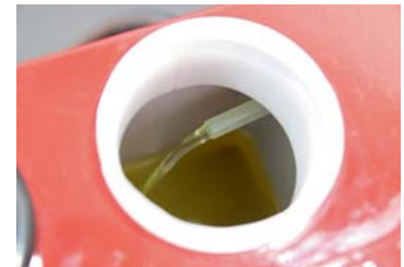
Schritt 6: Das Additiv wird während der Reinigung immer wieder ins Gerät zurückgeleitet.
