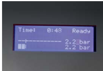
Schritt 5: Im Display kann man den Fortschritt des Reinigungsprozesses sowie den Druck ablesen.
