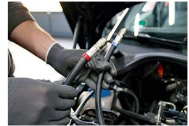
Schritt 2: Vor der Reinigung muss der Zu- und Rücklauf des Kraftstoffsystems an das Motul-Inject-System „3 in 1“ angeschlossen werden.
