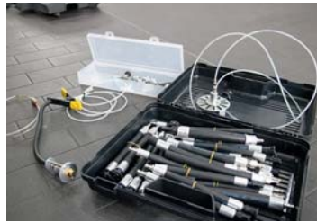
Schritt 1: Zur Ausstattung gehören viele Adapter für die Anschlüsse am Vor- und Rücklauf des Kraftstoffsystems sowie für die Reinigung des Dieselpartikelfilters.
