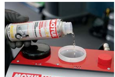
Schritt 4: Das passende Additiv wird direkt in den Vorratsbehälter des Gerätes eingefüllt.
