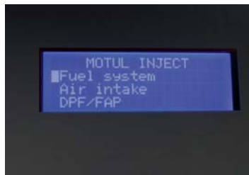
Schritt 3: Im Menü des Gerätes wird der Programmierpunkt Injektorreinigung ausgewählt.
