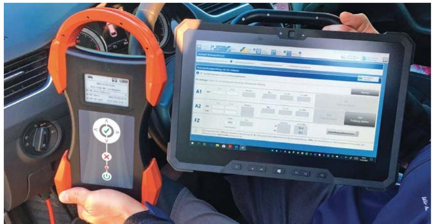
Der HU-Adapter ist Kernbestandteil der Hauptuntersuchung über die elektronische Schnittstelle.
