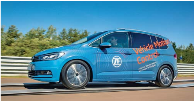
Mit aktiviertem Flying-Carpet-System können vertikale Bewegungen des Fahrwerks durch Anpassen der Dämpfer ausgeglichen werden.
