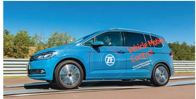
Bei deaktiviertem Flying-Carpet-System sorgen Bodenunebenheiten für spürbare Hubbewegungen im Fahrzeug.
