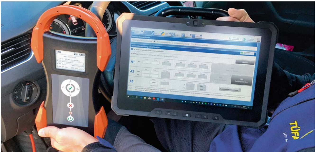
Der HU-Adapter ist ein wertvolles Instrument bei der Hauptuntersuchung: Über die OBD-2-Schnittstelle können Informationen zu den sicherheitsrelevanten Funktionen aus den entsprechenden Steuergeräten abgerufen werden.
