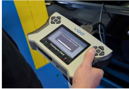
Mit einem Diagnosegerät lässt sich die Parkbremse in Servicestellung bringen.
