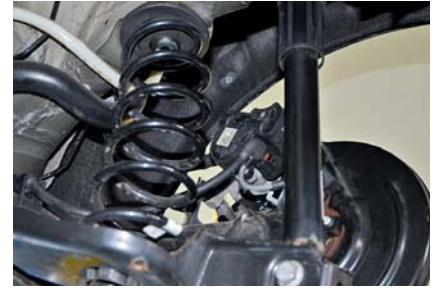
Die Steckverbindungen der elektrischen Parkbremse werden als Erstes gelöst.
