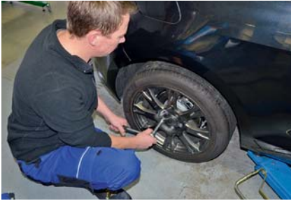
Um Zugang zur Parkbremse zu bekommen, muss das Hinterrad demontiert werden.
