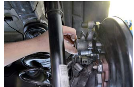
Vor dem Befestigen des Motors muss die neue Dichtung am Bremssattel angebracht werden.
