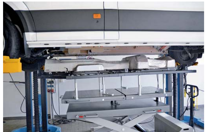
Die Batterie lässt sich relativ einfach aus dem Unterboden lösen und wird auf einem Scheren-Hubtisch stabilisiert.
