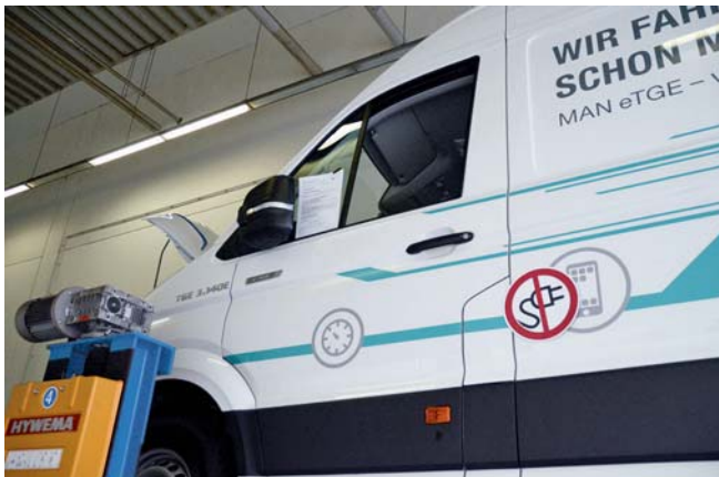
Roter Aufkleber und Zettel am Fenster warnen, wenn am Hochvoltssystem Wartungs- und Reparaturarbeiten durchgeführt werden.
