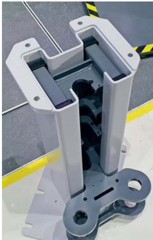
Das schweißnahtfreie H-Profil sorgt für Stabilität.
