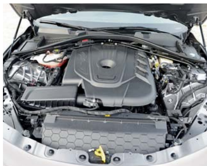
Der 2,2-Liter-Diesel leitet 190 PS und satte 450 Newtonmeter Drehmoment.
