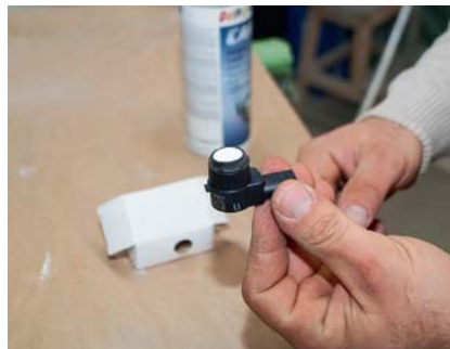
Die Gummi-Einfassung wird nicht mitlackiert, da der Lack dort mit der Zeit brüchig wird.
