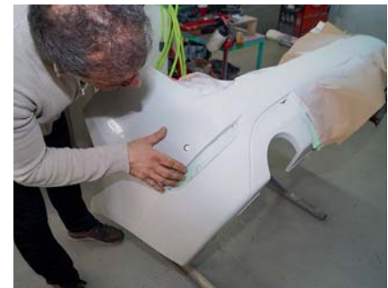
Beim Einbau des PDC-Sensors muss auf seine genaue Einbau-Position geachtet werden.
