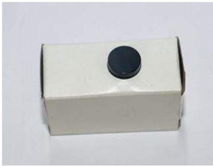
Eine spezielle Umverpackung der PDC-Sensoren erleichtert das Lackieren.
