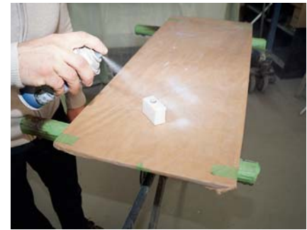
Die Lackierung eines PDC-Sensors erfolgt am besten mit einer Spraydose.
