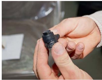
PDC-Sensoren werden für gewöhnlich immer unlackiert geliefert.
