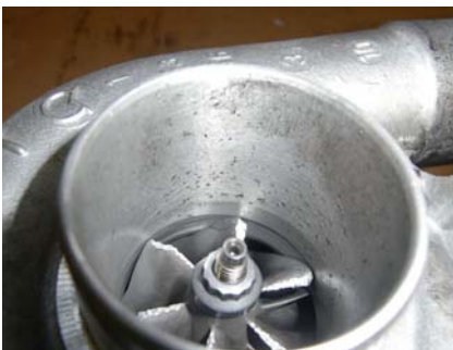
... und im Regelfall gut sichtbare axiale Schäden am Verdichterrad.
