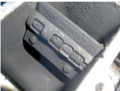
Ein defektes AGR-Ventil (defekter Lagerblock) sorgt für eine Verrußung des Turboladers.
