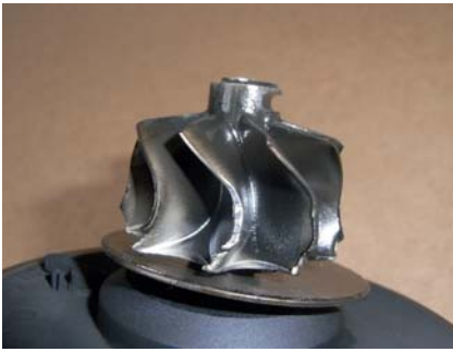
Fremdkörper verursachen radiale Schäden an den Schaufeln des Turbinenrades ...
