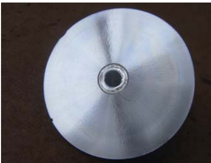
Die Rückseite des Verdichterrades ähnelt bei einem Überdrehschaden einer Orangenschale.
