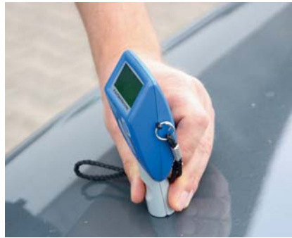
Unter der Oberfläche: Die Prüfung des Lacks auf mögliche Vorschäden ist wichtig.
