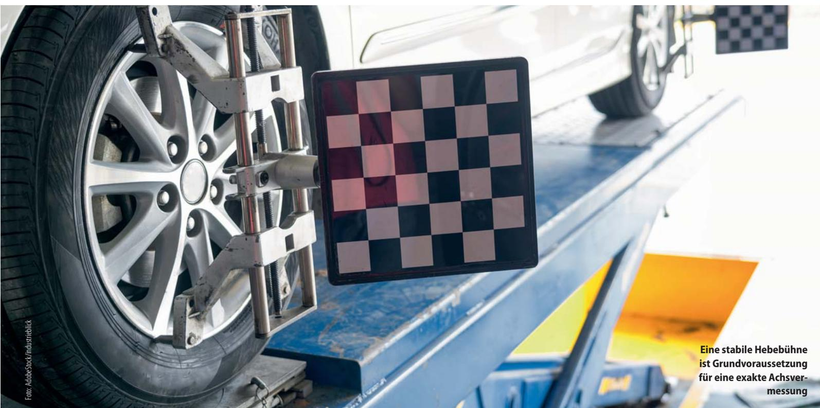
Eine stabile Hebebühne ist Grundvoraussetzung für eine exakte Achsvermessung
