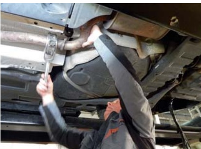
Mit einem Rohrschneider trennt Frühauf ein ausgemessenes Stück des Auspuffrohrs heraus.
