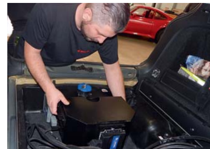
Der verkabelte AdBlue-Tank findet abschließend seinen Platz in der Reserveradmulde.
