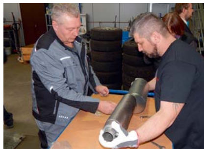
Waldemar Frühauf (l.) und ein Mitarbeiter montieren die Generator-/Katalysatoreinheit vor.
