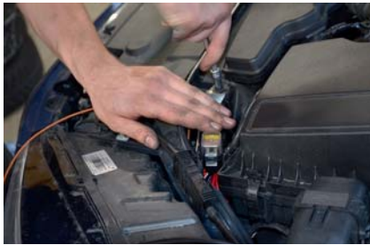
Sicherungshalter und Diagnosestecker der Heizung werden neben der Batterie befestigt.
