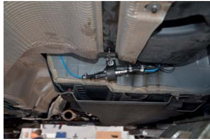
Die Dosierpumpe wird in der Nähe des Tanks mitsamt Kraftstoffleitung (blau) befestigt.
