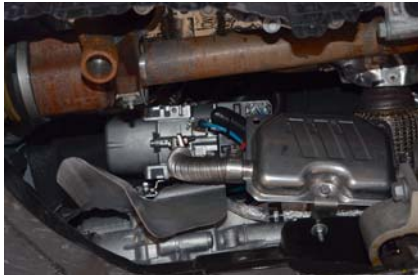
Heizgerät und Abgasschalldämpfer mit Verbrennungsrohr finden im Motorraum Platz.
