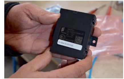
Das EasyFan-Steuerg r  bernimmt die Gebl se- und Klappensteuerung des Autos.
