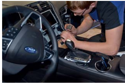
Im Innenraum werden Taster, Gebl sesteuerung und Temperaturf hler montiert.
