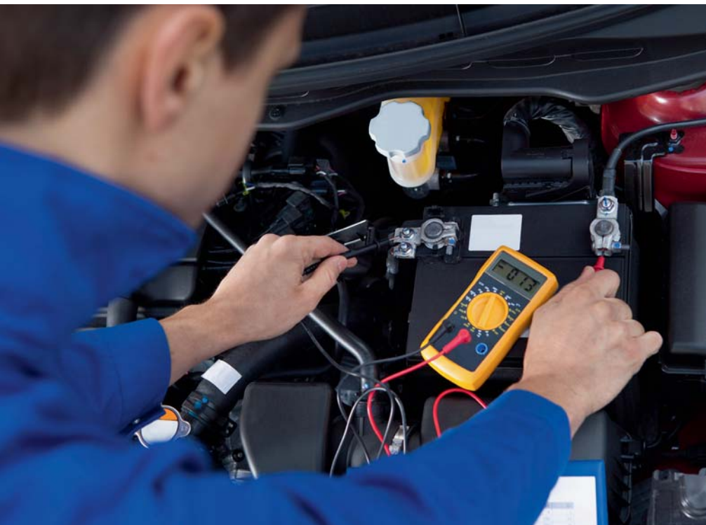
Mit einem Multimeter lässt sich die Ruhespannung der Batterie überprüfen.
