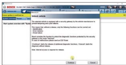
Mit dem Online-Sicherheitszertifikat wird der Zugang zum Fahrzeug freigeschaltet.
