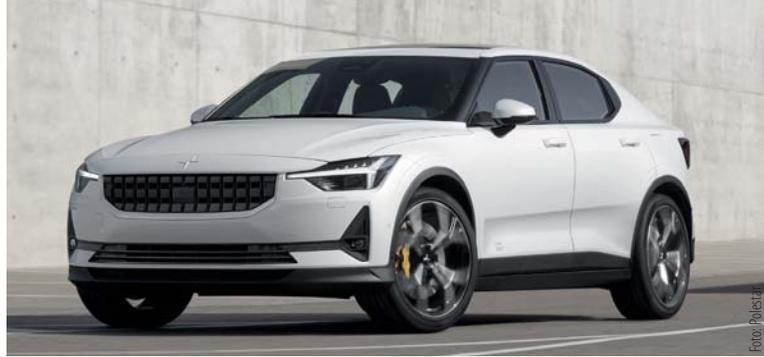
Ambitionierte Konkurrenz für Tesla Model 3: Der **Polestar 2** dürfte mit seinem Design beim Kunden punkten. Die technischen Eckdaten für den elektrischen Allradler versprechen einen Leistungssportler: Mehr als 400 PS Leistung und ein Drehmoment von 660 Nm. Die Akku-Kapazität beträgt 78 kWh, die Reichweite rund 500 Kilometer. Beschleunigung von 0 auf 100 km/h in weniger als fünf Sekunden.
