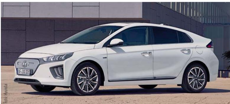
Facelift für den **Hyundai Ioniq Elektro**: Den Eckdaten zufolge steigt die Leistung auf 136 PS, das Drehmoment auf 295 Nm. Die Kapazität der Batterie soll sich auf 38 kW/h erhöhen, was eine Reichweite von rund 290 Kilometern ermöglichen dürfte. Die Homologation des Modells wollen die Südkoreaner im Rahmen der Markteinführung in Angriff nehmen.
