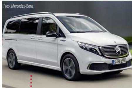
Der **Mercedes-Benz EQV** ist das zweite Serienmodell der Technologiemarke „EQ“. Highlights sind die intelligente Rekuperation und das üppige Raumangebot. Der Antriebsstrang an der Vorderachse leistet 204 PS und ein maximales Drehmoment von 362 Nm. Der Energiegehalt der Akkus liegt bei 100 kWh, die Reichweite bei rund 400 Kilometern (vorläufiger Wert).
