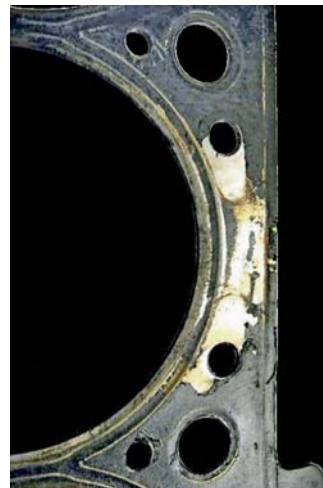
Ein unkontrollierter Verbrennungsablauf hat den Stegbereich der Dichtung zerstört.
