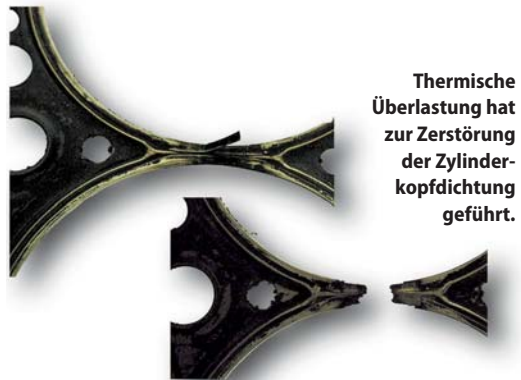
Schwarzfärbung ist ein deutliches Zeichen für ein Überblasen von Verbrennungsgasen.
