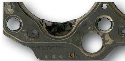
Durch sich lösende Teile treten massive Schäden an Motor und Zylinderkopfdichtung auf.
