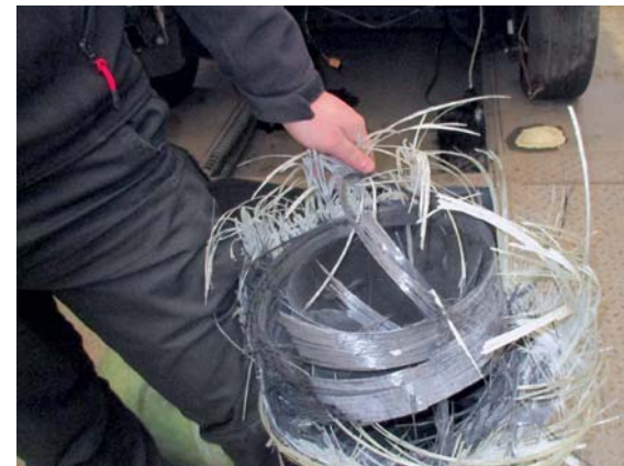
Das Endstück des zylinderförmigen Tanks hat es in einem Stück abgesprengt.
