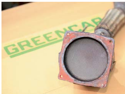
Vor der Reinigung: Der Ruß im Filter ist deutlich sichtbar.
