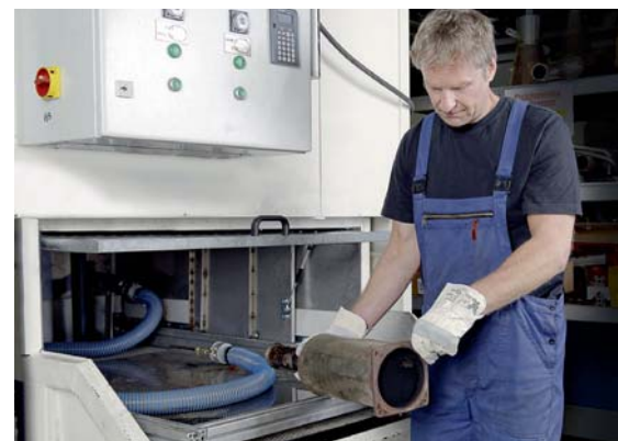
Oberland-Mangold reinigt die Partikelfilter, ohne das Gehäuse auseinanderzuschneiden.
