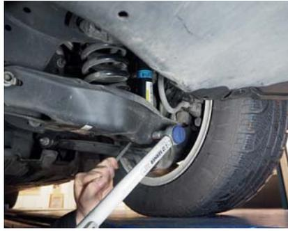
**Richtig:** Der Einbau sollte am Fahrwerk unter Normalbelastung und korrekten Anzugsmomenten durchgeführt werden.
