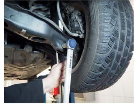
**Falsch:** Festziehen der Schrauben bei frei hängenden Rädern führt zu Verspannungen. Folgeschäden am Dämpfer sind vorprogrammiert.
