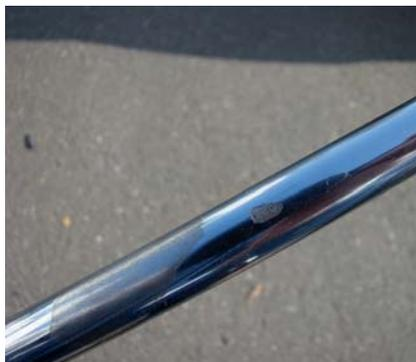
**Verbogen durch Verspannung: Abschürfungen an der Kolbenstange (links unten) zeugen von falschem Einbau. In der Mitte: Steinschlag-schaden wegen fehlenden Schutzrohrs.**
