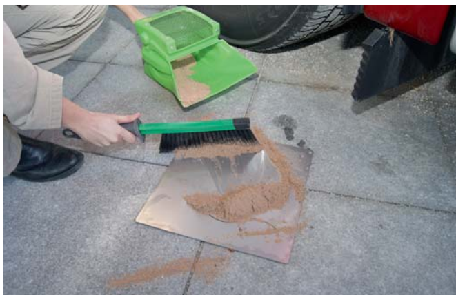
Mit einem geeigneten Besen wird das Bindemittel in die Flüssigkeit „einmassiert“.
