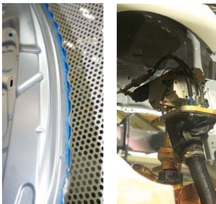
An den Falzen kommt Klebstoff zum Einsatz (links); Hohlraumwache werden per Roboter aufgetragen (rechts).
