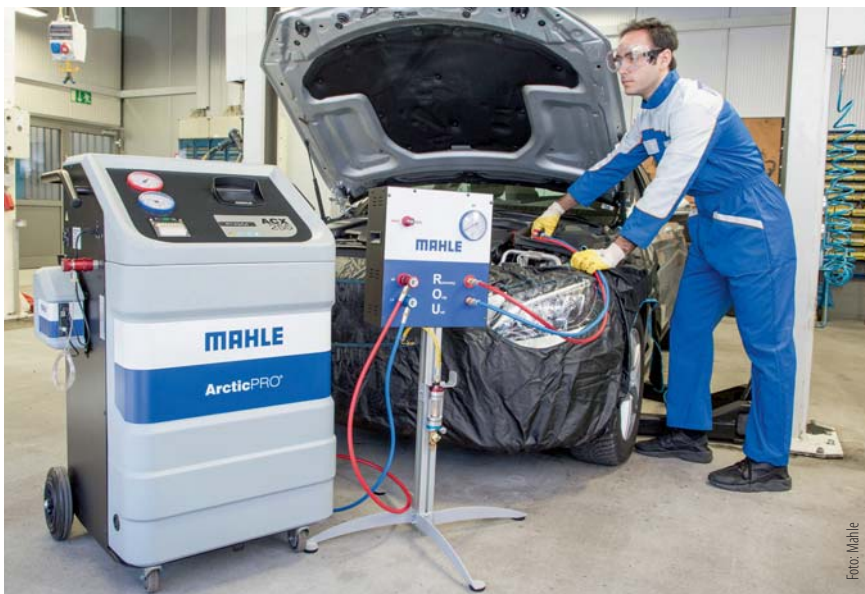
Die Klimaservicegeräte von Mahle/Brainbee sind mit einer Recovery-Unit zur Abführung von kontaminierten Gasen ausgestattet.
