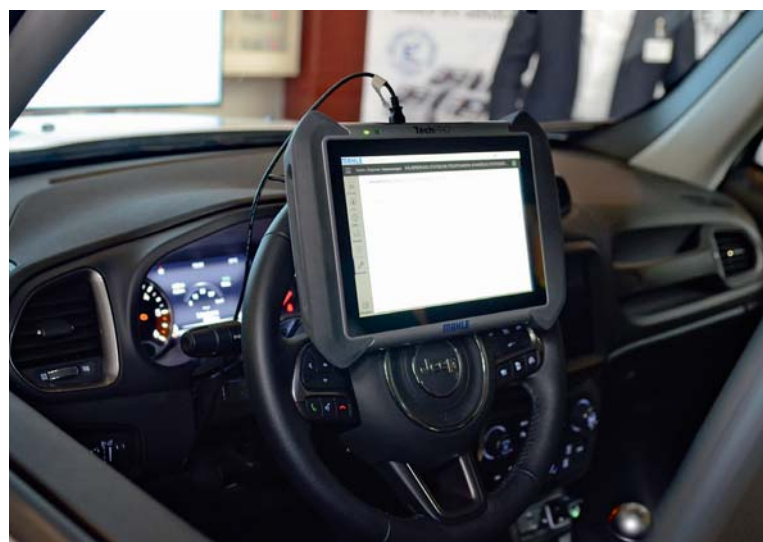
Die Kommunikation mit dem Fahrzeug läuft über das Diagnosegerät TechPro, das per VCI (Vehicle Communication Interface) an die OBD-Schnittstelle angeschlossen ist.
