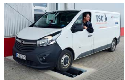
Fertig eingebaut, wird der neue Bremsprüfstand direkt getestet.
