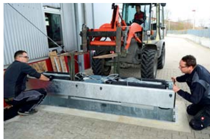
Mit dem Gabelstapler lässt der Werkstattinhaber den neuen Prüfstand langsam nach unten.
