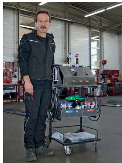
Mietsam nutzt das Gerät JetClean Tronic II zur Reinigung von Kraftstoff- und Ansaugsystem.
