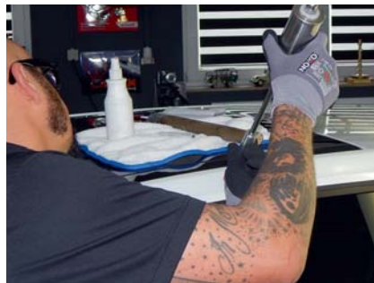
Harter Brocken: die Hageldelle im Dachholm zieht Marx mit dem Gleithammer heraus.
