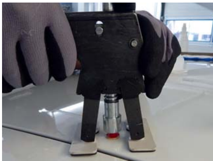
Für weiches Blech eignet sich der Dellenlifter besonders gut.
