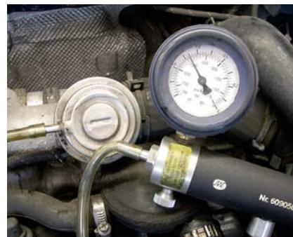
**Dichtigkeitsprüfung eines AGR-Ventils an einem Dieselmotor mittels Handpumpe**
