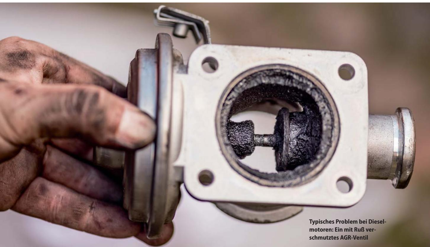
Typisches Problem bei Dieselmotoren: Ein mit Ruß verschmutztes AGR-Ventil
