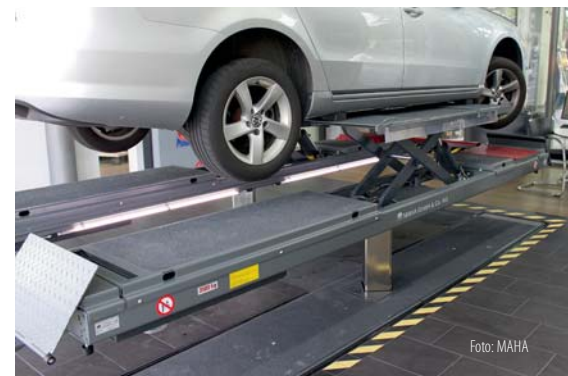
Bei den Unterflurbühnen von MAHA verhindert der Bodenausgleich Unfälle.
