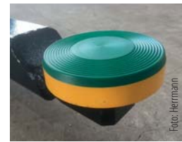
Steckpilze mit Lastsensoren melden bei Herrmann-Hebebühnen, wenn die Lastverteilung kritisch ist.
