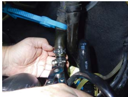
... anschließend erfolgt die Einbindung des Systems in den Kühlmittelkreislauf.
