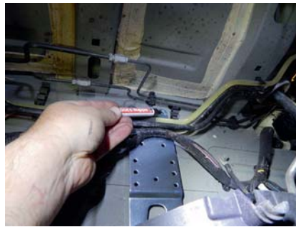
Die Bohrungen zur Aufnahme der Heizung werden vorgezeichnet.
