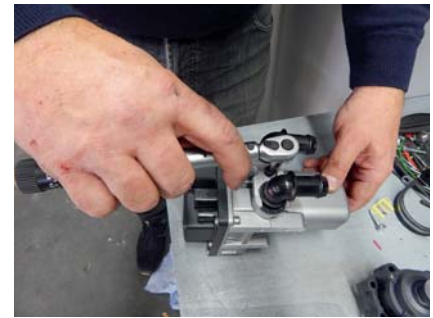
Die Halterung der Wasseranschlüsse ist mit Drehmoment nach Vorgabe anzubringen.
