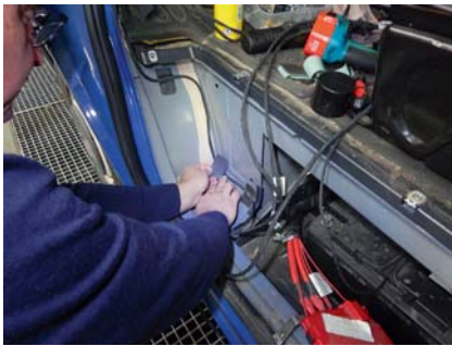
Zunächst verkabelt der Monteur das Gebläse-Relais und die Batterie.
