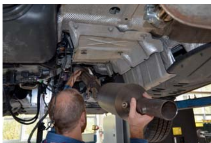
Der Abgasstrang mit SCR-Kat ersetzt passgenau das Abgasrohr des T5 bis zum Mitteltopf.
