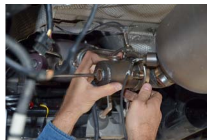
Nach Montage müssen \text{NH}_3 -Generator und AdBlue-Injektor angebracht werden.
