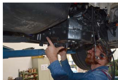
Der AdBlue-Tank des T6 passt auch in den T5 – mit leichten Modifikationen an der Halterung.
