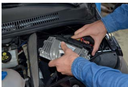
Das eigens entwickelte Steuergerät sorgt für die korrekte Dosierung im SCR-Katalysator.
