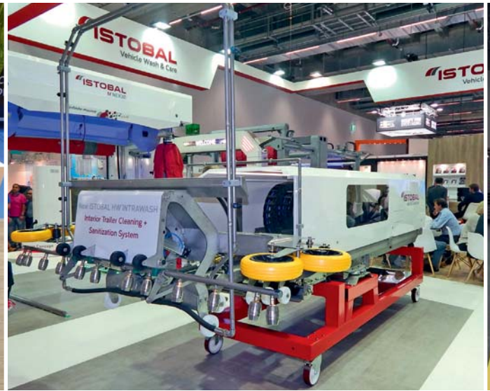
Automatische Innenreinigung und Desinfektion von Kühlanhängern oder Containern ermöglicht die Intrawash von Istopal.
