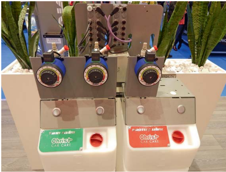
Die neue Dosierpumpenstation von Christ kann dank gesetzeskonformer Auffangvorrichtung an beliebiger Stelle stehen und bietet einfaches Handling.
