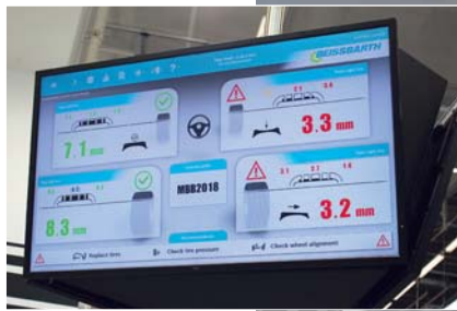
Exakte Reifen-Profil-tiefenmessung via Kamera und farbcodiertem Licht bei Beissbarth
